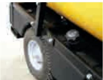
Большие пневматические колеса, слоты для вилочного погрузчика, прочный пластиковый топливный бак.
