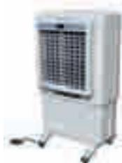
Охладители воздуха Master охлаждают воздух, используя простой и натуральный процесс испарения воды. Вода, закачиваемая насосом из резервуара, увлажняет большой целлюлозный фильтр, через который с помощью вентилятора высокой производительности равномерно нагнетается воздух. Испаряющаяся с поверхности фильтра вода снижает его температуру на несколько градусов, благодаря чему в помещении поступает холодный, свежий воздух.
