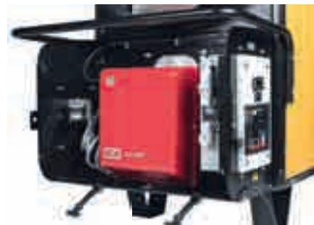
Внутри защитного бокса: горелка Riello,
